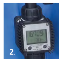
2. Contalibri digitale K24. Digital flowmeter K24.
