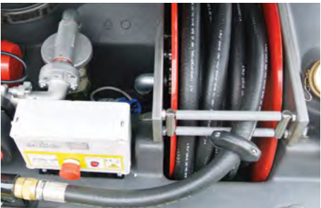
Il quadro elettrico e l'arrotolatore. Electric switchboard and spring rewind hose reel.
